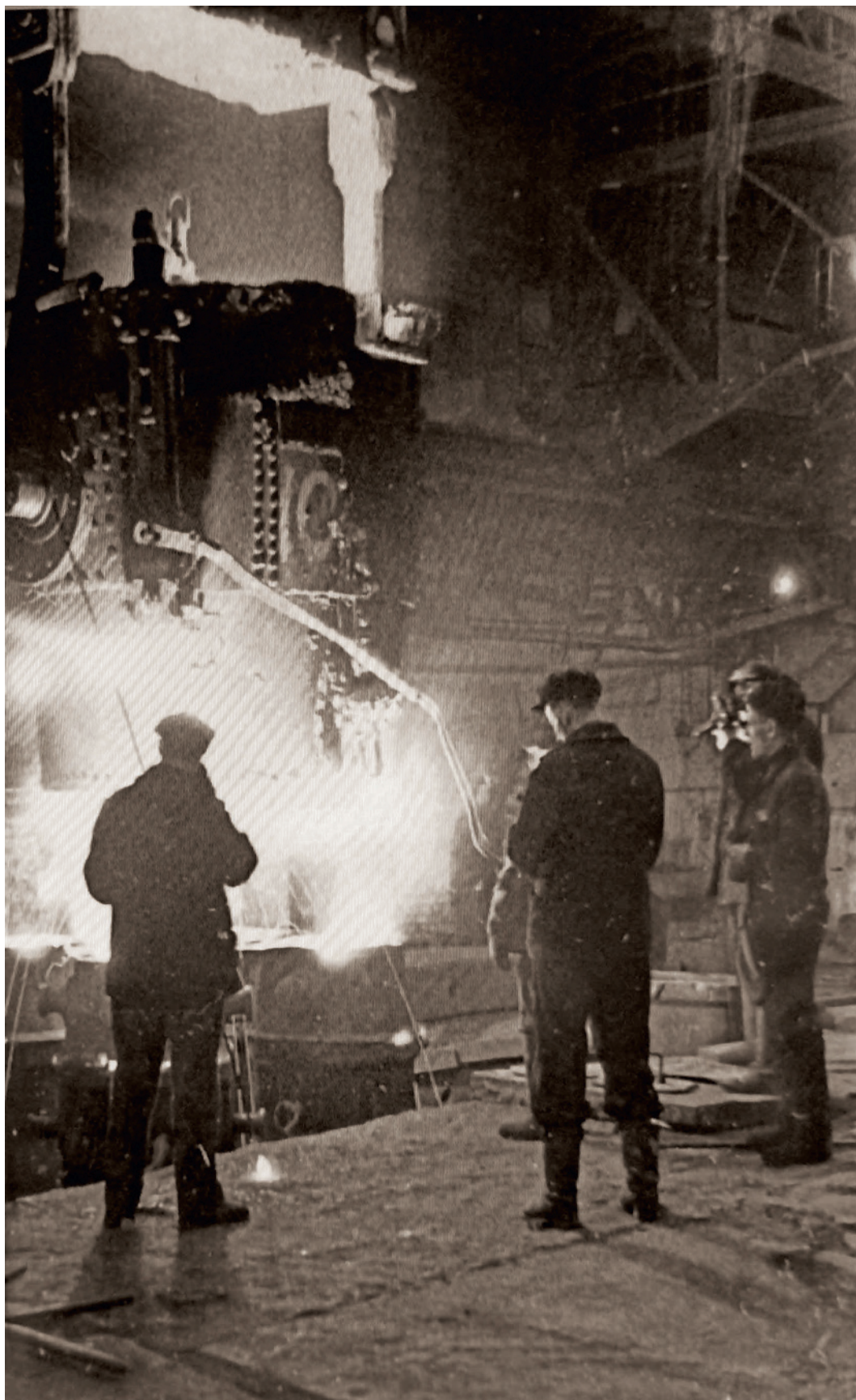
Разлив стали из разливочного ковша в изложницы в электросталеплавильном цехе Златоустовского металлургического завода. 1952. — ОГАЧО. Ф. Р-2012. Оп. 3. Д. 948. Л. 1
