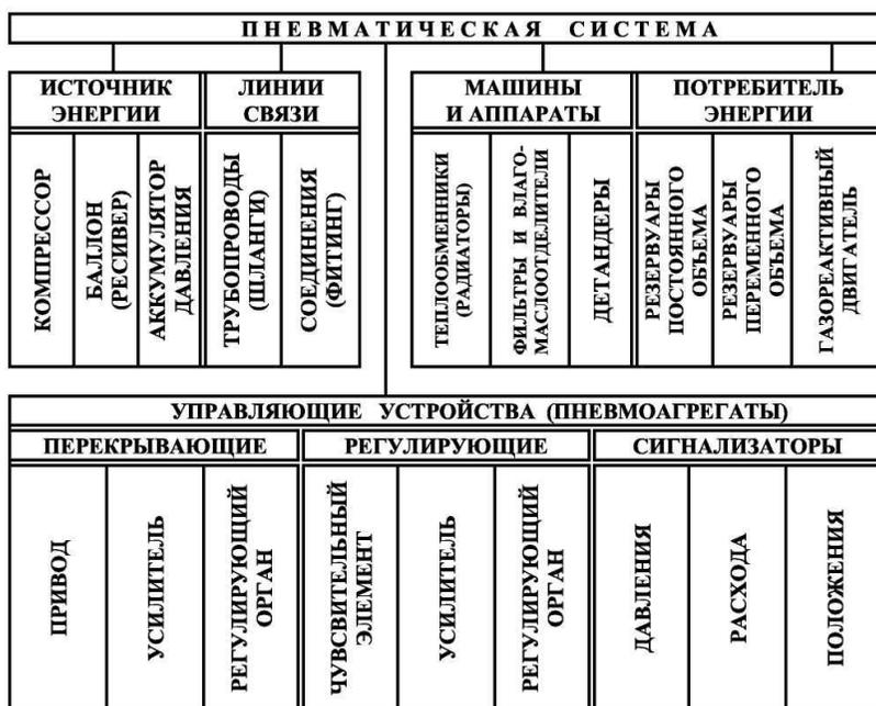
Рис. 2.1. Составные элементы пневмосистемы
