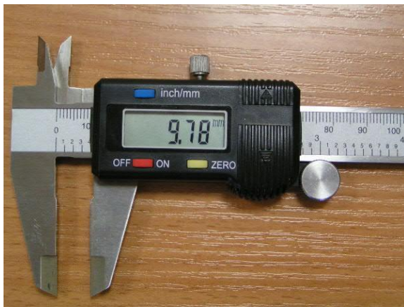
Рис. 23. Штангенциркуль с электронной шкалой
