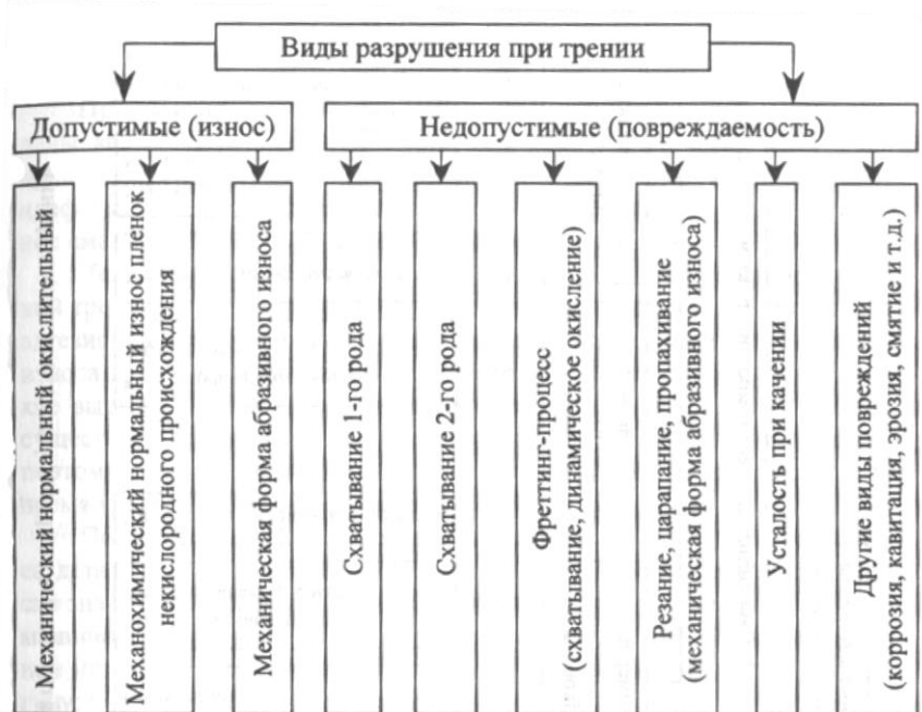
Рис. 1.2. Классификация видов разрушения при трении
