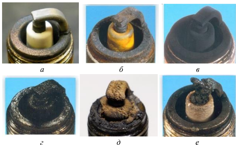
Рис. 1.3. Внешний вид состояния свечей зажигания а – нормальный вид; б – свинцовые отложения; в – бархатисто-черный нагар; г – масляный нагар; д – зольные отложения; е – оплавление и частичное разрушение электродов свечи
