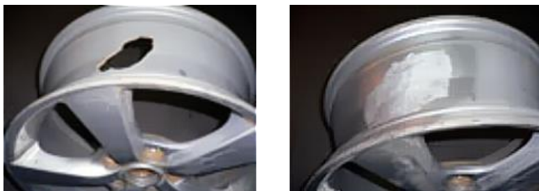
Рис. 3.6. Автомобильные диски: дефектный ( a ) и восстановленный наплавкой ( б )
