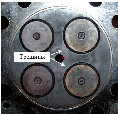
Рис. 3.19. Трещины в головке цилиндров
