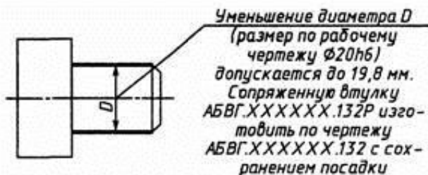
Рис. 3.39. Пример исчерпывающих указаний об изготовлении сопряженного изделия
