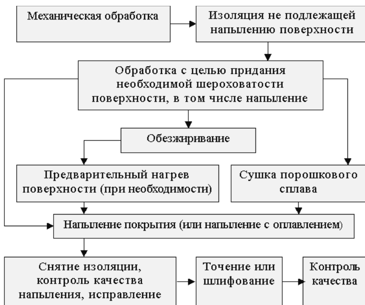
Рис. 2.19. Технологический процесс плазменного нанесения покрытий
