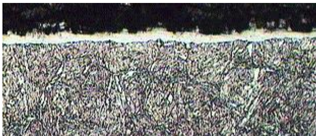
Рис. 2.9. Белый слой твердого карбонитрида на поверхности детали
