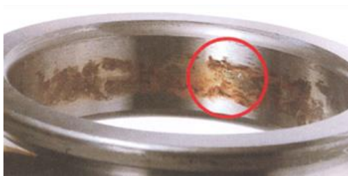
Рис. 1.36. Фреттинг-коррозия на внутреннем кольце радиального подшипника
