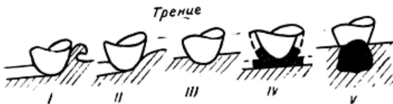
Рис. 1.1. Классификация видов износа (по И. В. Крагельскому)
