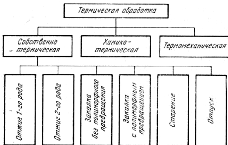
Рис. 1.27. Виды и разновидности термической обработки сталей и цветных металлов и сплавов
