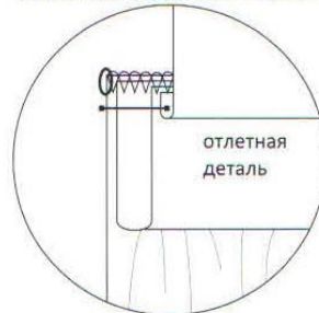
4. Втачивание рукава в пройму.
