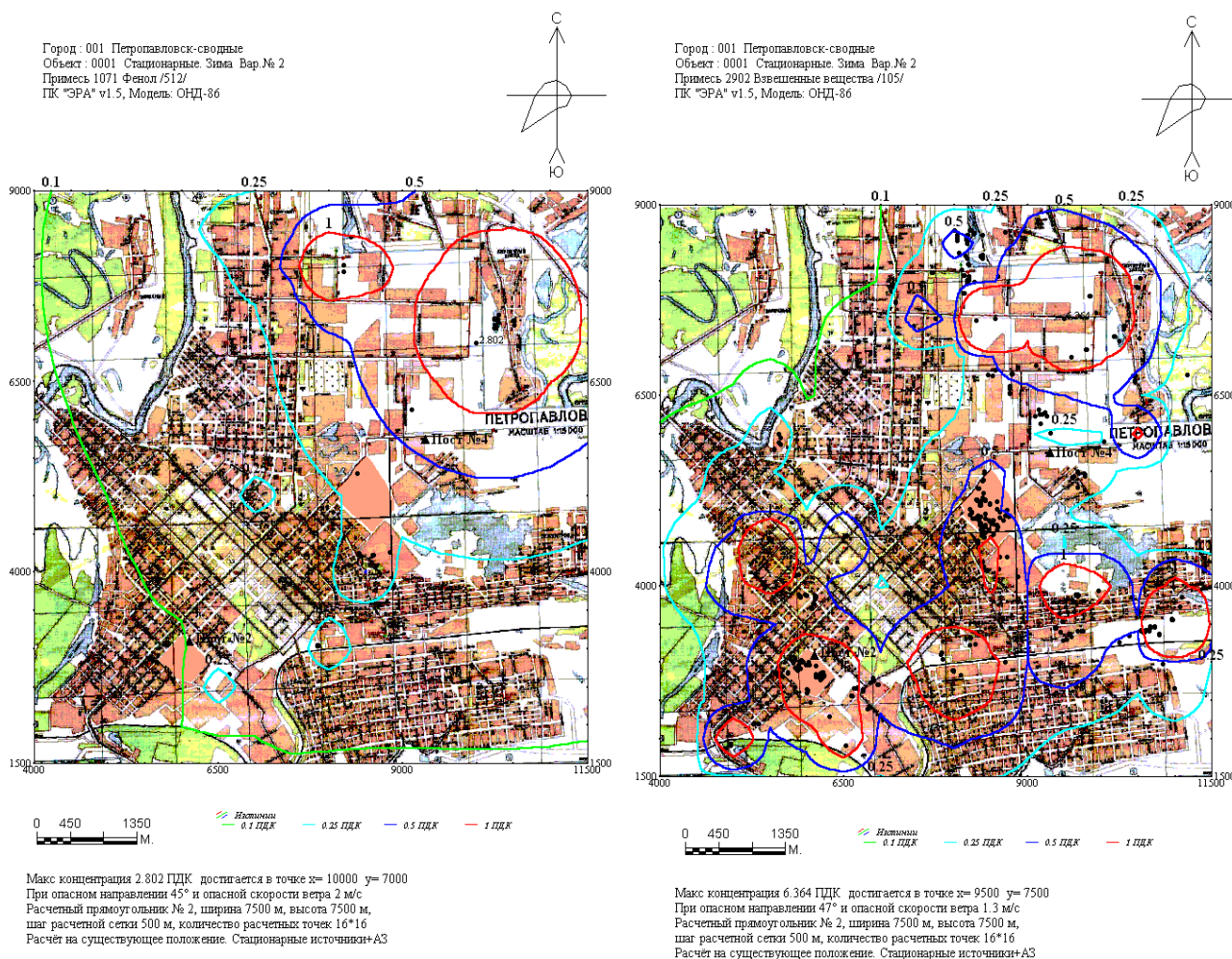
Рис.4 Карты приземных концентраций загрязняющих веществ в атмосфере г. Петропавловска (фенол, взвешенные вещества)
