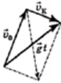
Рисунок 24 – Векторный треугольник скоростей
