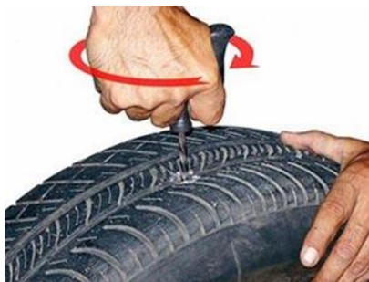
Рис. 1.14 – Фиксация грибка в проколе автомобильной шины
