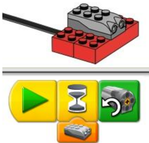
Рис. 18 – Моделирование с датчиком расстояния
