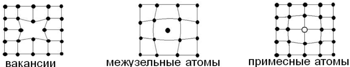
Рис.2.4 Точечные дефекты кристаллической решетки
