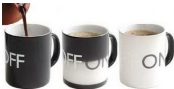
Рис. 5.1. Термохромная краска на кружках
