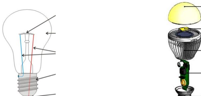
Рисунок 20 – Строение лампы накаливания и светодиодной лампы
