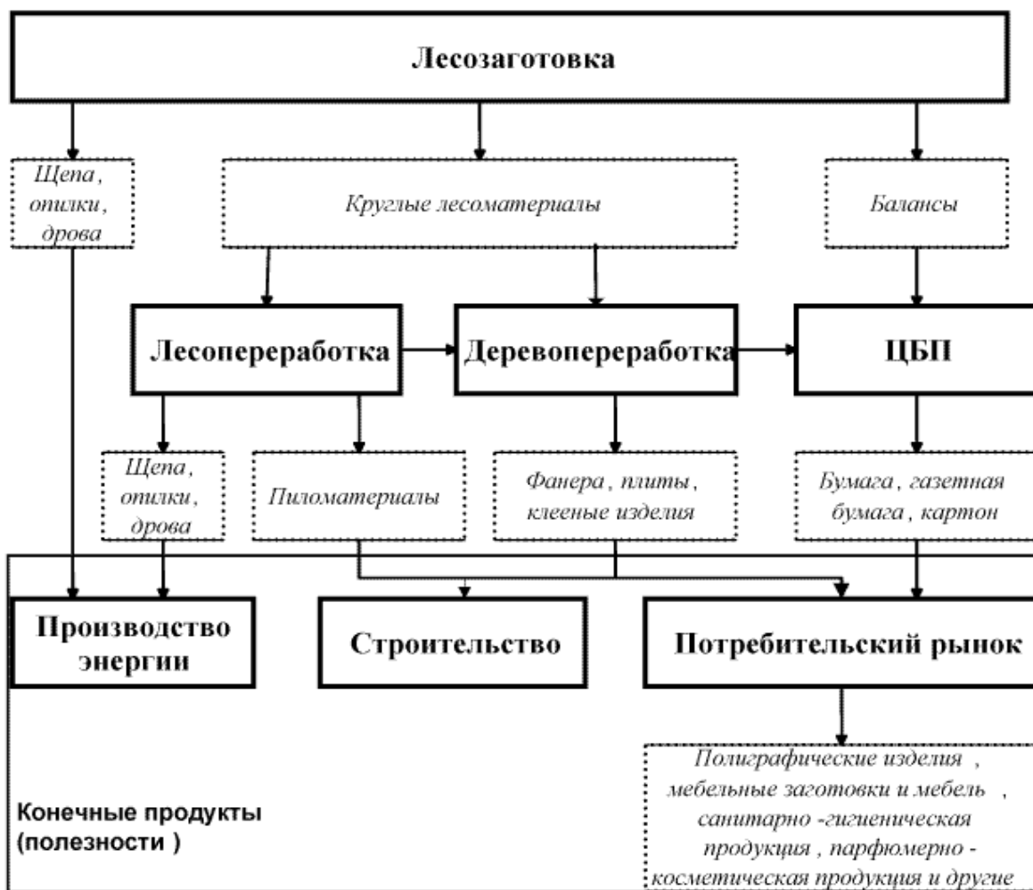
Рис. 75. Технологический цикл заготовки и переработки древесины
