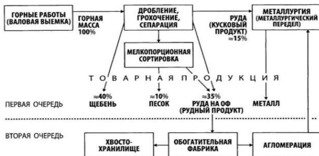
Рис. 53. Технологический цикл добычи и обогащения железных руд
