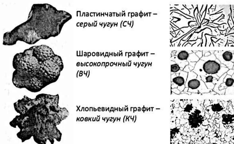
Рисунок 1.4 – Схематическое изображение формы графитных включений и реальные микроструктуры чугунов с различной формой графита в феррите [13]
