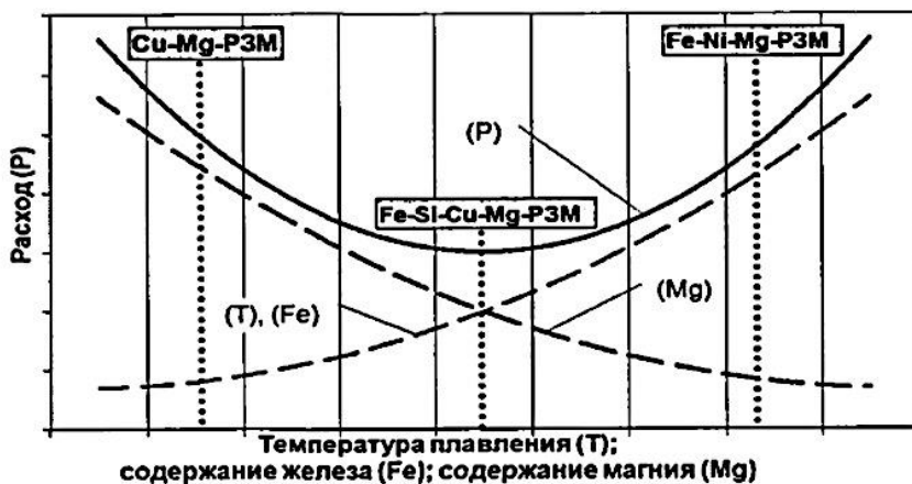
Рисунок 3.5 – Схема влияния железа, магния и температуры плавления на расход «тяжелой» лигатуры [140]
