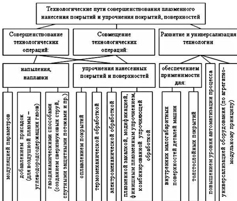
Рисунок 4.16 – Технологические пути совершенствования плазменного нанесения и упрочнения покрытий, поверхностей [223]
