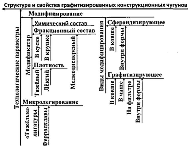
Рисунок 3.4 – Диаграмма причинно-следственных связей (диаграмма Исикавы) комплексного влияния технологических параметров на структуру и свойства графитизированных конструкционных чугунов
