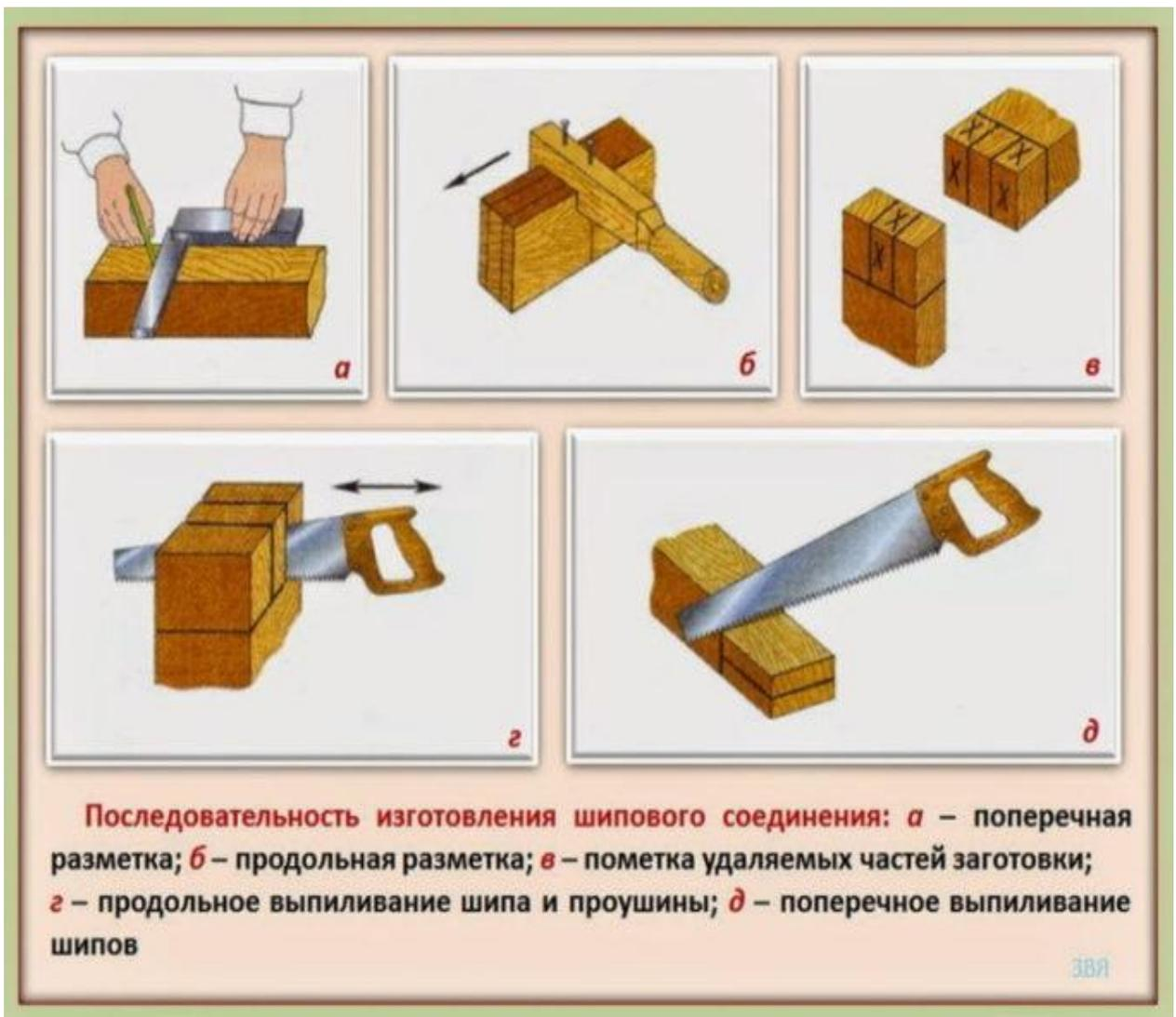
*Рис.12 Последовательность изготовления шипового соединения*
