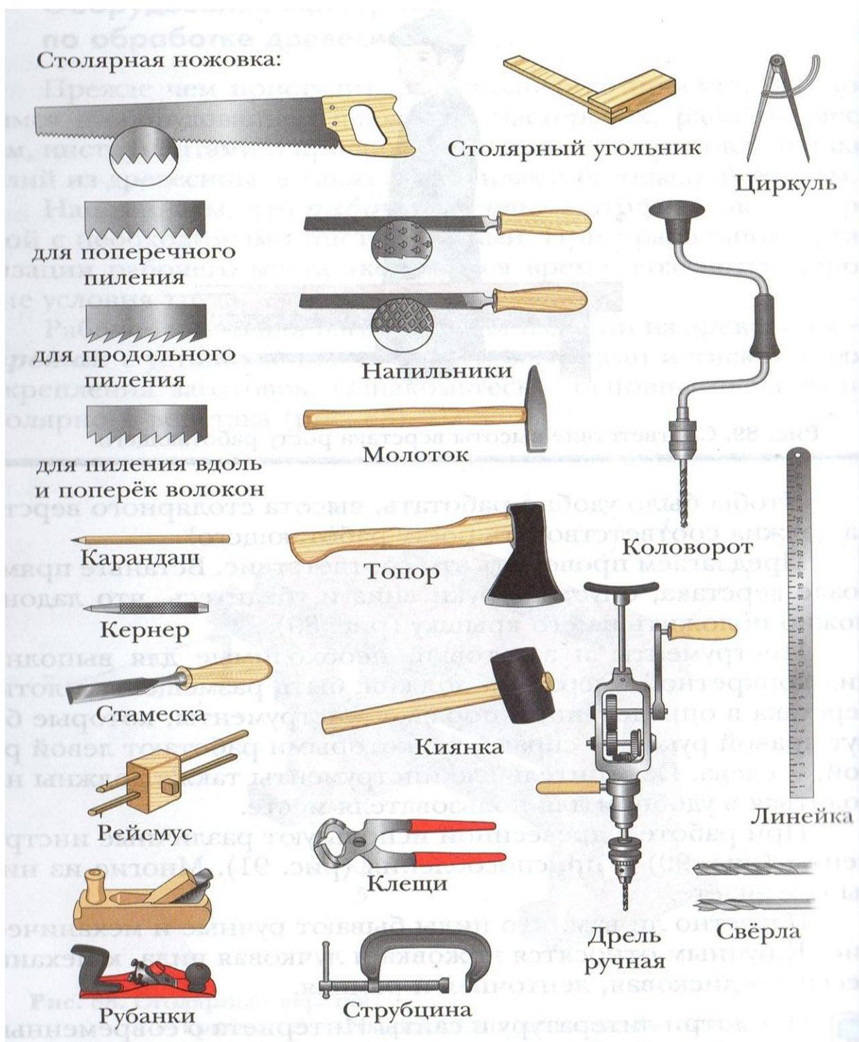
Рис 5. Виды ручного инструмента для обработки древесины
