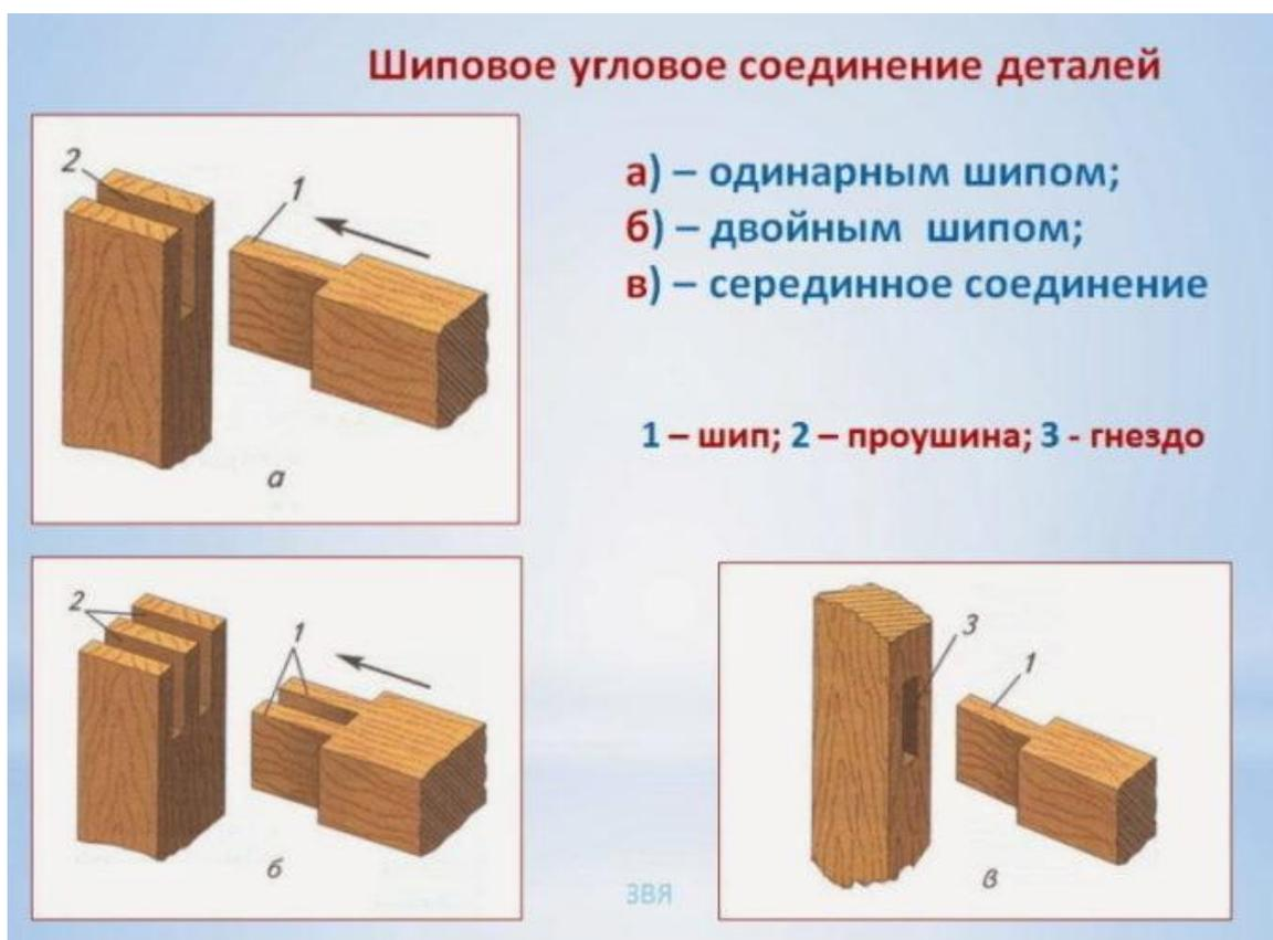
*Рис.11 Шиповое угловое соединение деталей*
