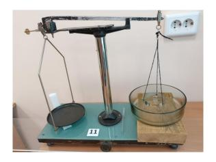
Погрузив проволочное кольцо определенного диаметра, подвешенное к правому коромыслу весов в исследуемую жидкость, можно наблюдать взаимодействие молекул жидкости и кольца.
