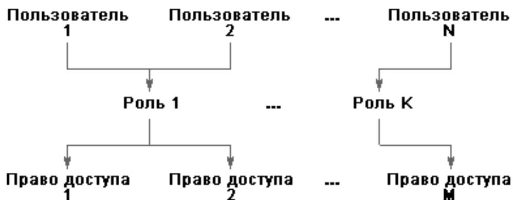
Рисунок 14 – Схема ролевого управления доступом.
