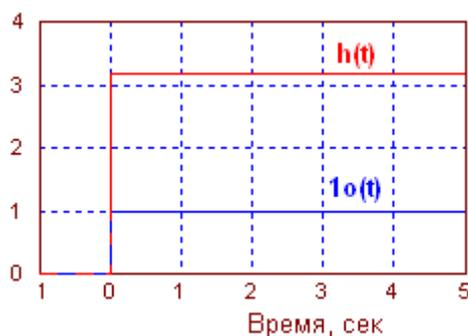
Рис. 4.3.5. Переходная функция пропорционального звена
