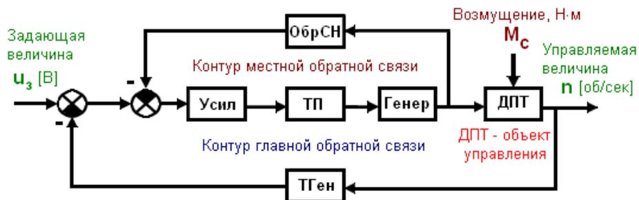
Рис. 4.5.4. Функциональная схема системы автоматического регулирования двигателя постоянного тока
