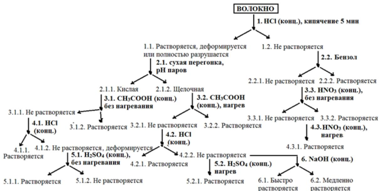
Рисунок 29 – Схема экспресс-анализа текстильных волокон [22]
