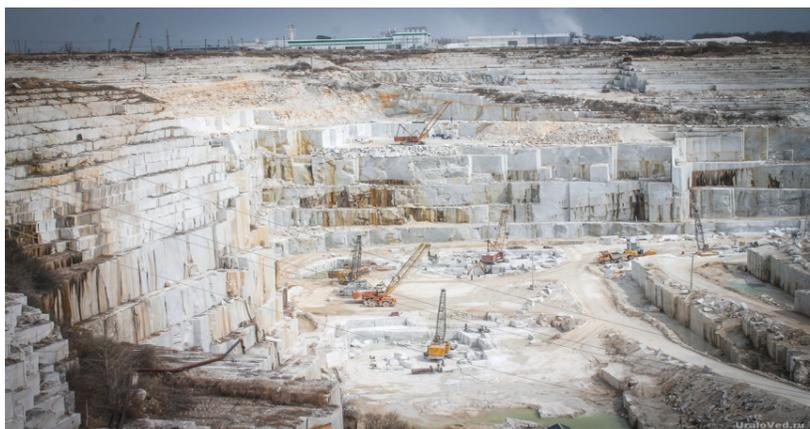
Для добычи мрамора снимают верхний слой земли. С помощью специальных пил отделяют огромные глыбы и перевозят на самосвалах к месту обработки. Какие же изделия получаются после обработки мрамора?
