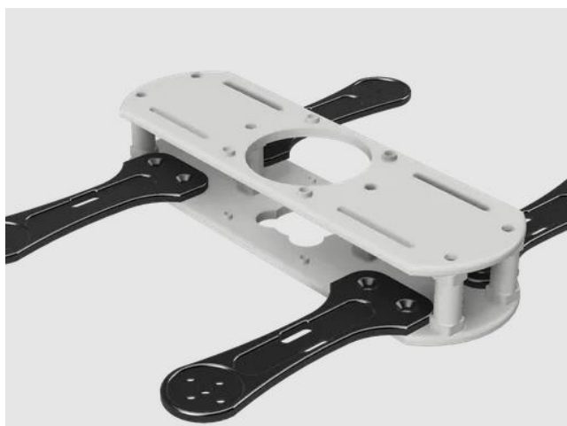
Рисунок 8 – Рама квадрокоптера из пластика
