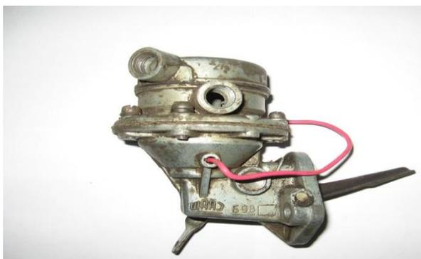
Рисунок 1 – Внешний вид насоса-расходомера
