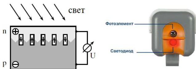
Рис. 34. Функциональная схема фотодиода [48]. Внешний вид датчика освещенности
