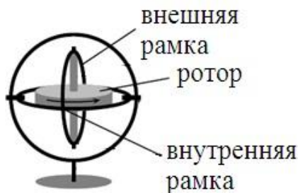
Рис. 45. Схема трехстепенного механического гироскопа
