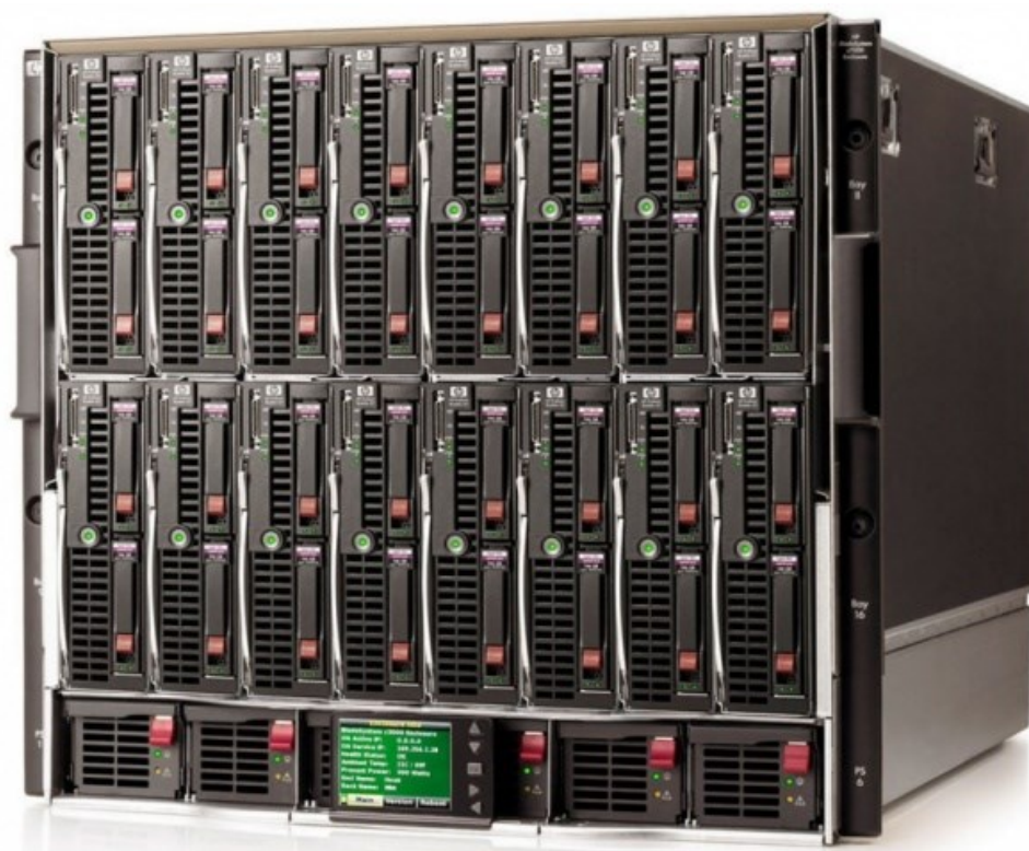
Рисунок 1.21 – Пример серверной стойки с blade-серверами
