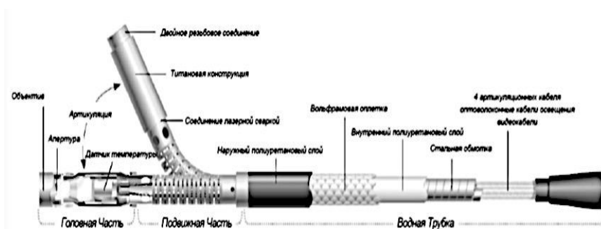
Рисунок 3.3.14 – Видеозонд системы Everest XLG3 [38]
