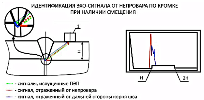
Рисунок 2.3.30 – Идентификация эхо-сигнала от непровода по кромке шва при наличии смещения [17]:
