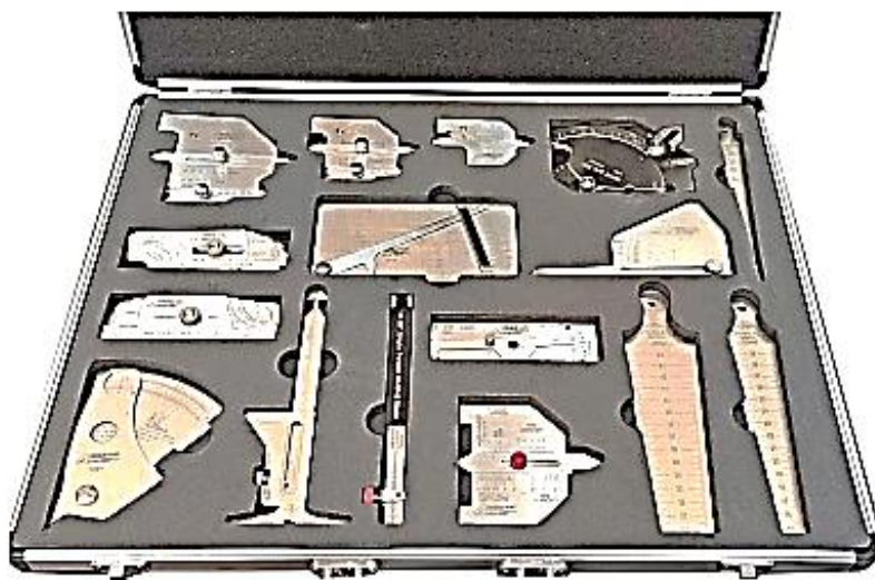
Рисунок 2.1.3 – Набор шаблонов сварщика с первоначальной калибровкой [4]
