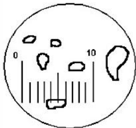
Рисунок 3.3.15 – Вид дефектов в окуляре эндоскопа [38]
