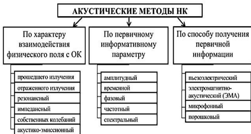
Рисунок 2.3.1 – Классификация акустических методов контроля по ГОСТ 18353-79 [11]
