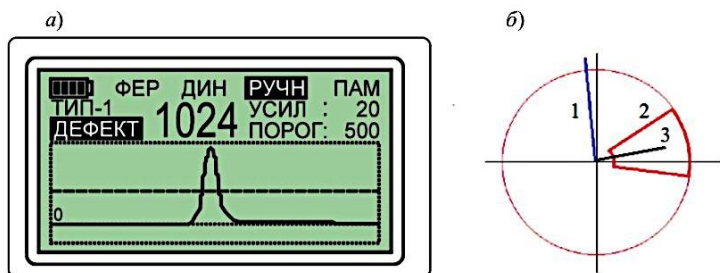
Рисунок 2.4.9 – Представление информации о дефекте на временной развертке (а) и на комплексной плоскости (б) [20]:
