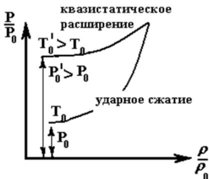
Рис. 44. Различия в начальном и конечном состояниях газа
