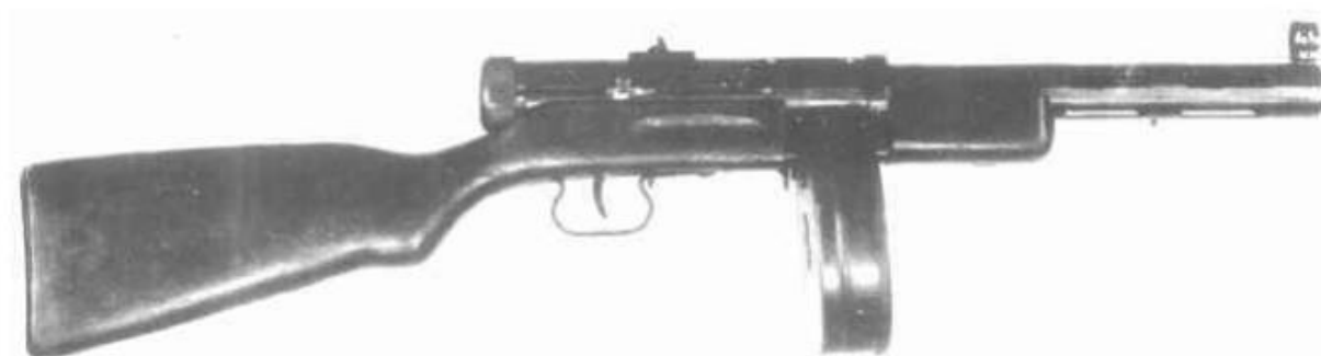
7,62-мм пистолет-пулемет системы Дегтярева образца 1940 г. ППД-40
