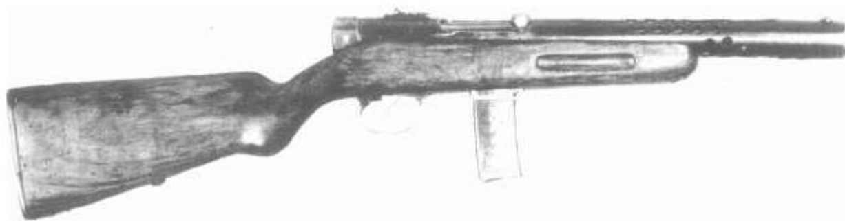
7,62-мм пистолет-пулемет системы Токарева, опытный образец 1931 г.
