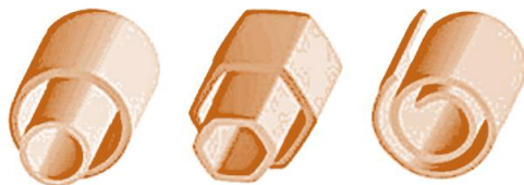
Рис. 2.8. Возможные структуры многослойных нанотрубок: а) «русская матрешка»; б) шестигранная призма; в) свиток [22]
