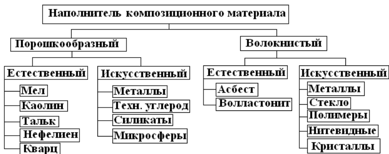
Рис. 1.4. Классификация композиционных материалов по виду наполнителя [2]
