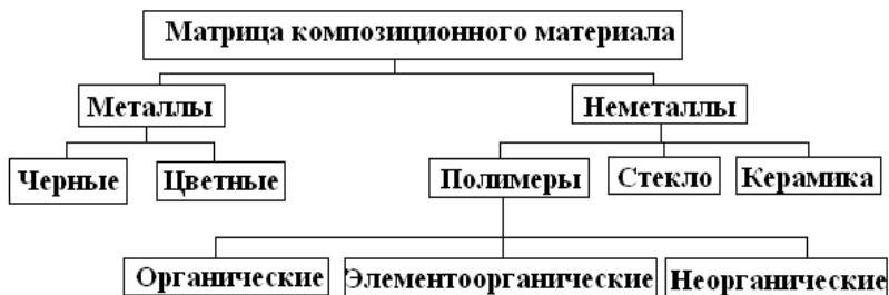
Рис. 1.3. Классификация композитов по виду матрицы [2]
