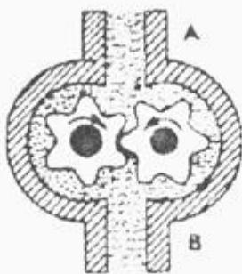
47. В каком направлении будет двигаться вода в системе шестерёнчатого насоса, если его шестерня вращается в направлении стрелок?
