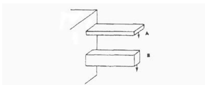
36. Бруски А и В имеют одинаковые сечения и изготовлены из одного и того же материала. Какой из брусков может выдержать больший вес?
