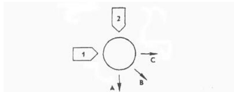
5. Если на круглый диск, указанный на рисунке, действуют одновременно две одинаковые силы 1 и 2, то в каком направлении будет двигаться диск?
