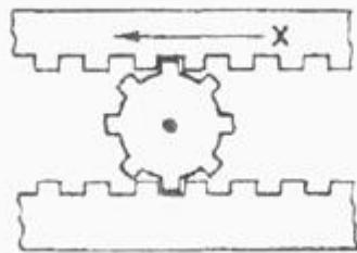
50. Зубчатая рейка X движется полметра в указанном стрелкой направлении. На какое расстояние при этом переместится центр шестерни?
