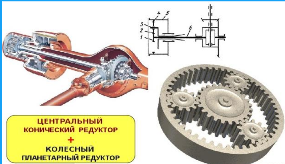
Разнесенная двойная главная передача автомобилей МАЗ
