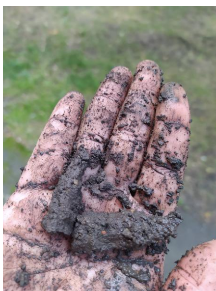
Рисунок 17 – Определение гранулометрического состава почвы полевым способом – средний суглинок (фото автора)
