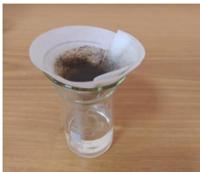
Рисунок 18 – Получение водной почвенной вытяжки (фото автора)
