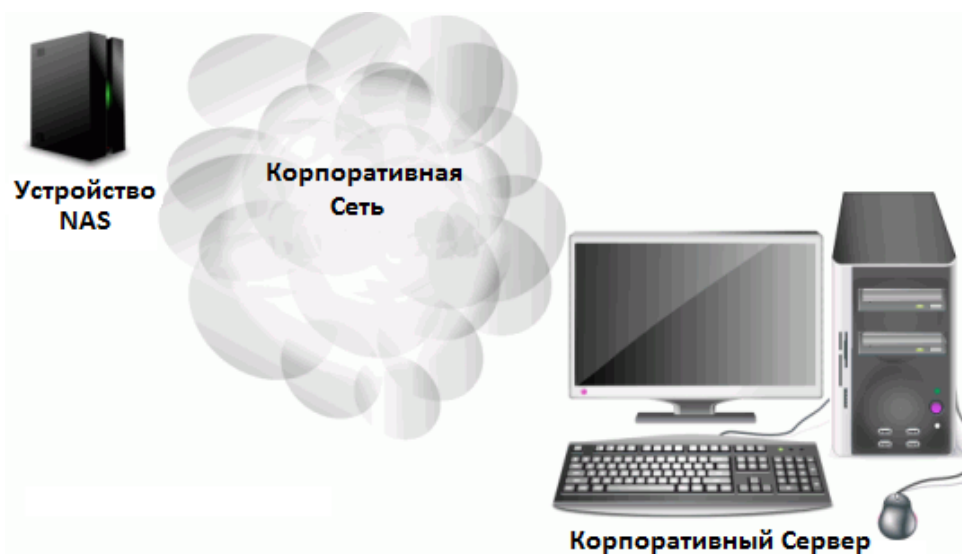
Рис.9. Рекомендуемая схема сети при резервном копировании небольшого корпоративного сервера
