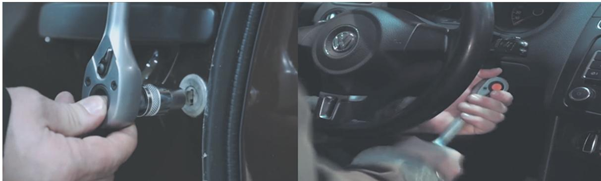
Рис. 2. Взлом замка двери и замка зажигания «занозой»
