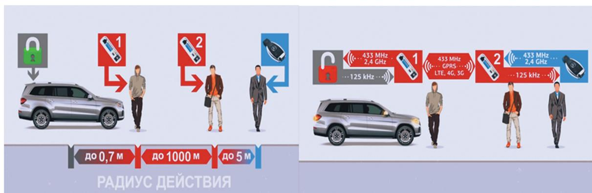
Рис. 9. Схема действия угонщиков с ретранслятором
