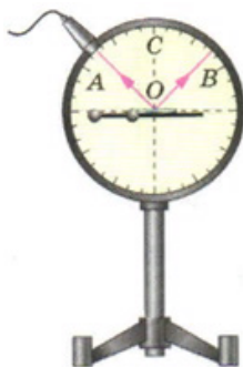
Рис. 13. Прибор для наблюдения изменения угла падения света
