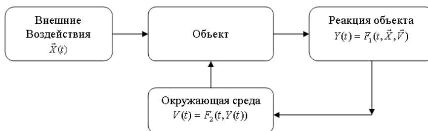
Рис. 4.1. Структура модели элемента типа «черный ящик».
