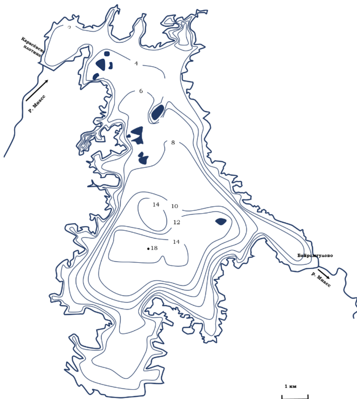
Рисунок 7 - Схема батиметрии Аргазинского водохранилища (копировано автором)
