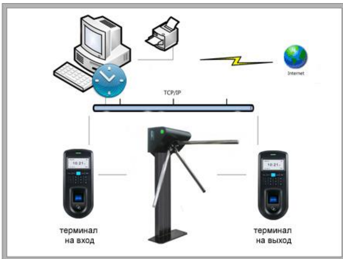
Рисунок 17 – Схема подключения терминала к локальной сети
