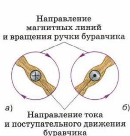
Рис. 95. Применение правила буравчика: проводник с током расположен перпендикулярно плоскости чертежа
