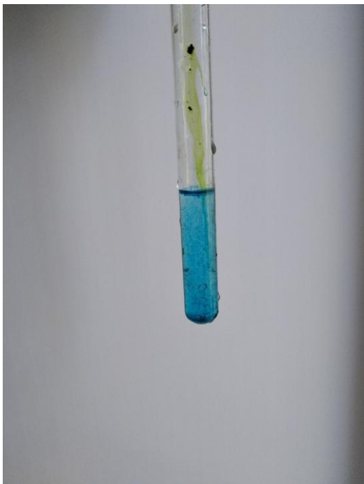
Рис. 32 Качественная реакция на фталоцианины
