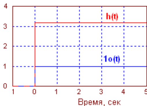
Рис. 2.12. Переходная функция пропорционального звена
