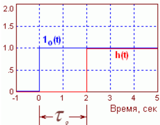
Рис. 2.16. Переходная функция звена запаздывания
