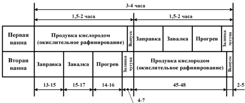
Рисунок 3.26 – График совмещения операций при плавке стали в двухваннных печах и примерная их продолжительность (% от общей длительности плавки)[41]
