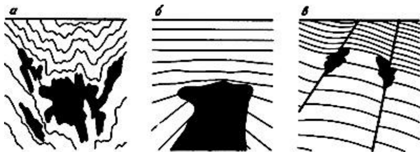
Рисунок 1.2 – Рудные тела (залито черным) изометрической формы [1]:
