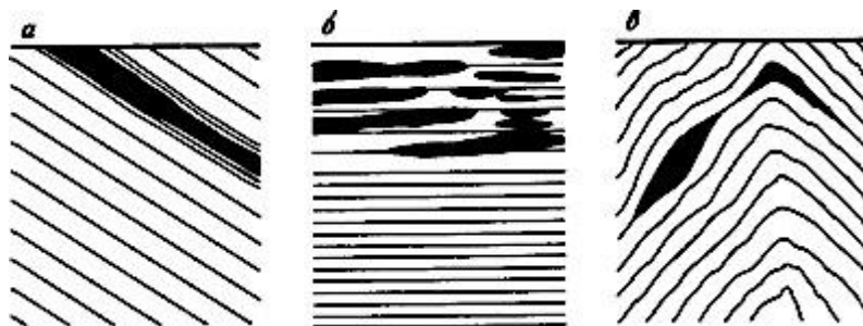
Рисунок 1.3 – Рудные тела пластообразной формы [1]:
