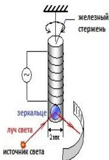
Рис. 31. Схема опыта Эйнштейна и де Гааза
