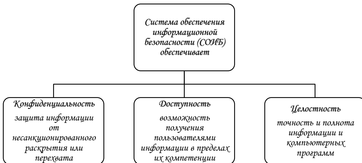
Рисунок 1 – Компоненты системы обеспечения информационной безопасности
