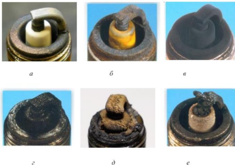
Рис. 7.1 – Внешний вид состояния свечей зажигания: а – нормальный вид; б – свинцовые отложения; в – бархатисто-черный нагар; г – масляный нагар; д – зольные отложения; е – оплавление и частичное разрушение электродов свечи
