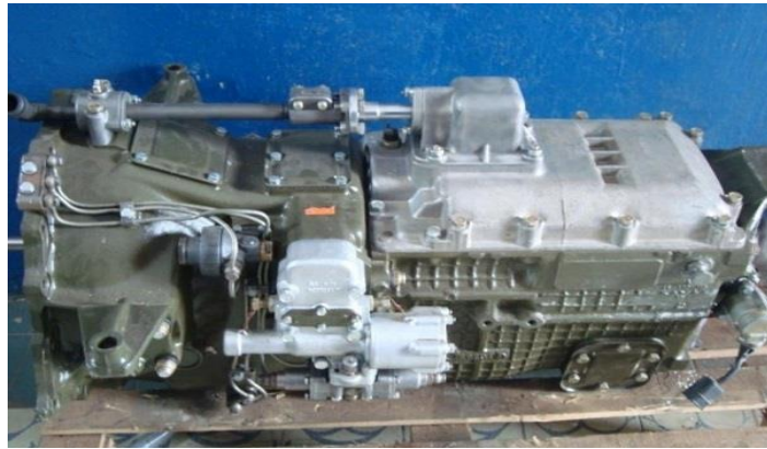
Рисунок 6 – Внешний вид коробки передач автомобиля КАМАЗ-5320
