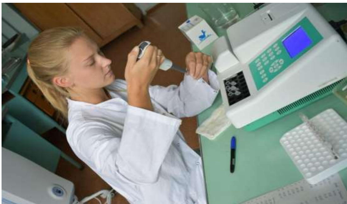
Рисунок 2.1 – Выполнение биохимических исследований крови птицына проточном биохимическом анализаторе SINNOWA BS3000P (КНР)(лаборант-исследователь М. В. Кошечева)
