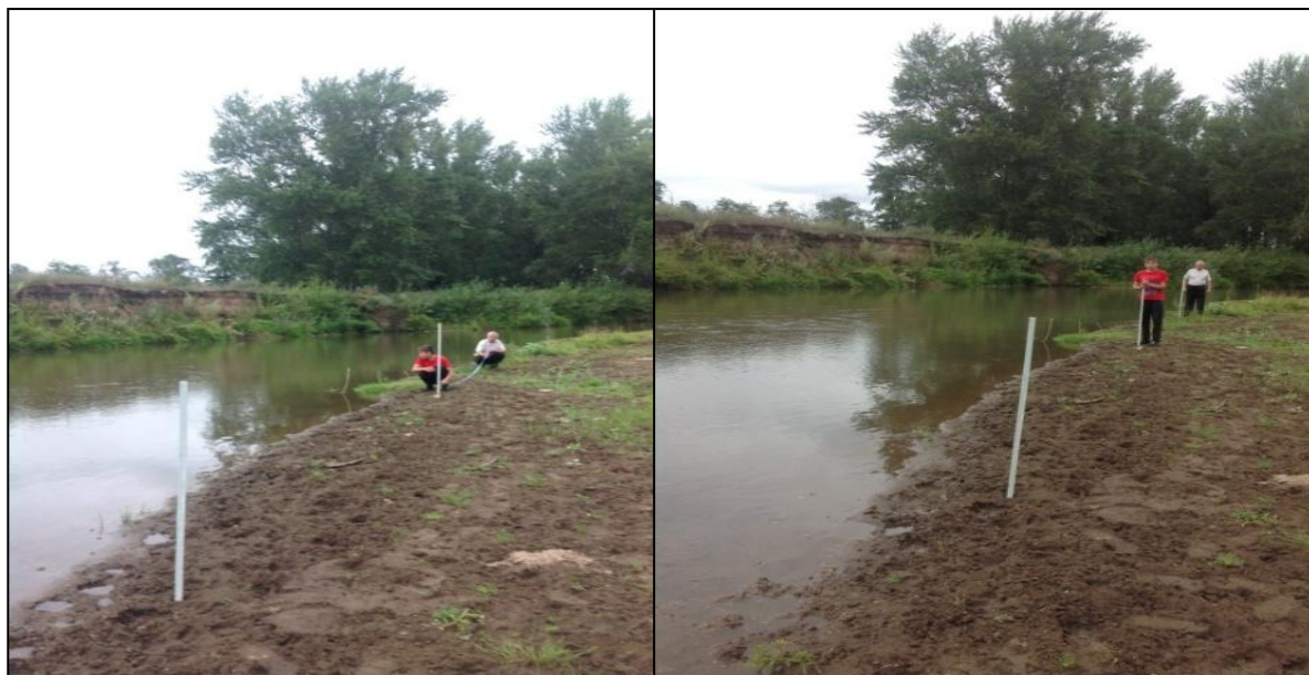
Установка реек для определения скорости течения рек
