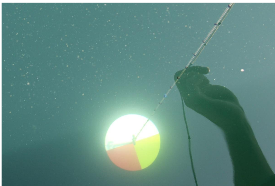
Рисунок 7 – Общий вид диска Захарова (измерение на глубине 2 м в озере Тургояк)
