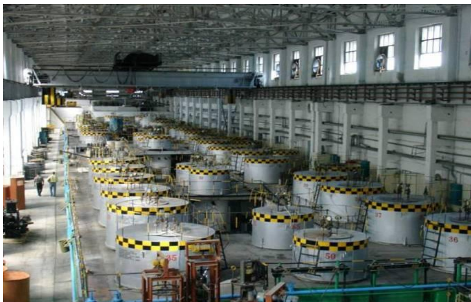
Рис. 4 Автоклавы для выращивания кварца гидротермальным методом на заводе «Кристалл» (фото автора, 2013г.)
