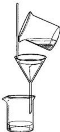
Рисунок 4.2 – Установка для фильтрования
