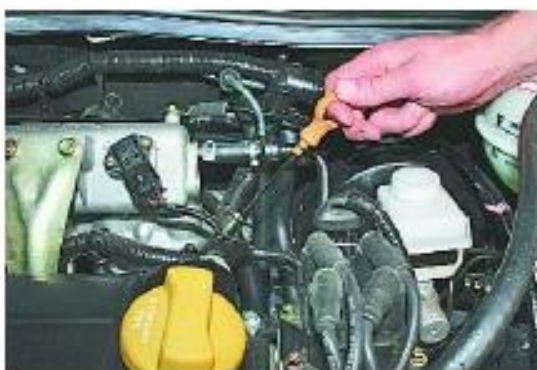
Рис. 2.16. Проверка уровня масла в картере двигателя
