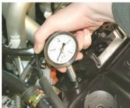
Рис. 2.12. Проверка компрессии в цилиндре двигателя
